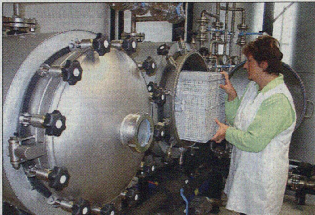
Bei klirrenden Minusgraden wird das vom Säurefraß bedrohte Papier in einer Art riesiger Waschtrommel deponiert. Sobald diese mit flüssigem Gas geflutet ist, werden 999 von 1000 aggressiven Ionen neutralisiert. So können Bücher gerettet werden. Foto: Preservation Academy
